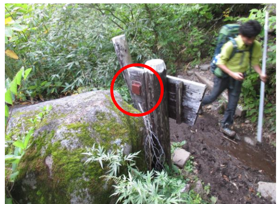
既存看板を活用して設置した機器
